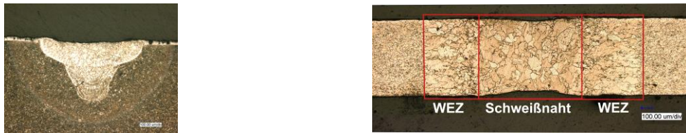
Abbildung 2: Metallografische Schiffe einer Schweißnaht eines hochfesten 22MnB5 Stahlwerkstoffs mit Aluminium-Silizium-Beschichtung (AlSi) und einer Materialstärke von 2mm (links) und einer Schweißnaht eines verzinkten DX56 Stahlwerkstoffs mit einer Materialstärke von 0,75 mm (rechts). Prozessparameter des DirectProcess900 Direkt-Diodenlaser Prototyp: P_L=252 W, z=0 mm, v_f=1 m/min, w_f=200 \mu m. WEZ: Wärmeeinflusszone.
