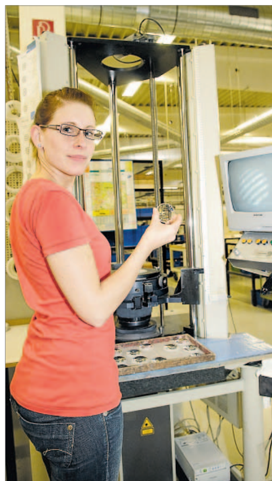
Noch eine Qualitätskontrolle: Mit diesem Gerät ist die Mitarbeiterin in der Lage, Fehler in der Struktur der Linsen ausfindig zu machen.
