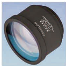
Die f-Theta-Kurzpuls Laserobjektiv S4LFT4010 für den infraroten und grünen Spektralbereich wird um eine für 355 nm optimierte Version erweitert.
