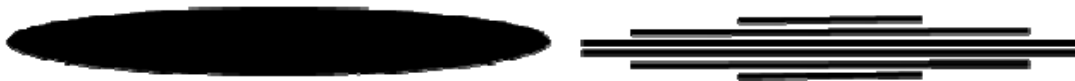
Abb.1: Links: Produktion von einer Spur mit variabler Spurweite Programmierung, rechts: Produktion der gleichen Geometrie mit mehreren Durchgängen.
